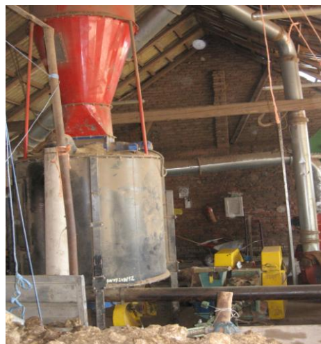
Rysunek 59. Urządzenie do odpylania instalacji Źródło: Materiały własne
